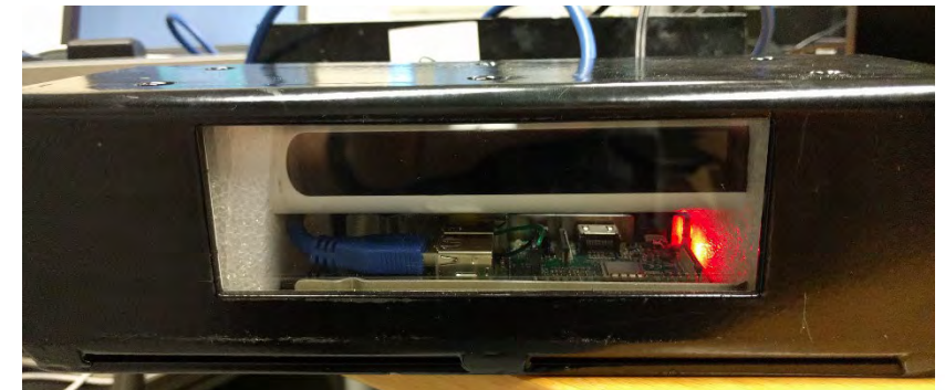
Gepanzerte Einheit – Sensor (oben) und Raspberry Pi (unten)
